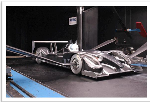
Aufgaben, Partner usw. Danach wurden wir in zwei Gruppen aufgeteilt und man zeigte uns die beiden Windkanäle, den AWTE und den LWTE (kleiner und grosser Windkanal). Der kleinere der beiden, so sagte man uns, wird hauptsächlich für Automodelle gebraucht. Er ist ein sogenannter offener Windkanal, sprich keine geschlossene Röhre. Es kann eine Windstärke von 180 km/h bzw. 50m/s erzeugt werden und er ist 3.8m mal 1.8m
